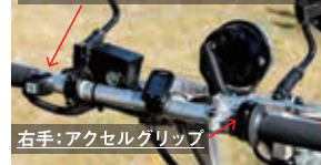
左手:制動ブレーキ用液圧式ハンドル
