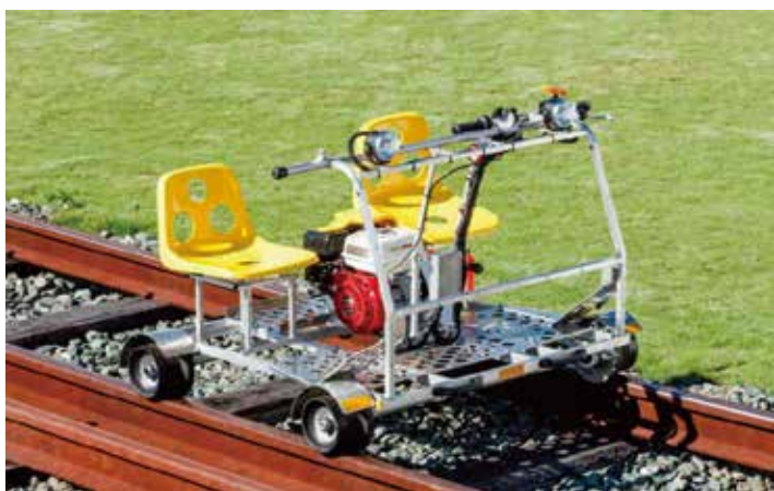
【RC-LZ2】(2人乗り,狭軌用,小径絶縁車輪,2輪駆動)
