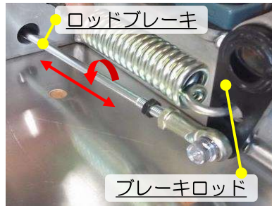
(24)前後のロッドブレーキを回して、突き出し長さを調整する。
