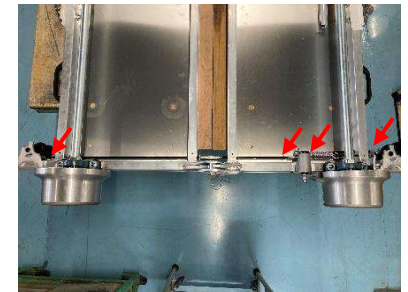
(12)ロッドブレーキのM8ナットを4箇所緩める。
