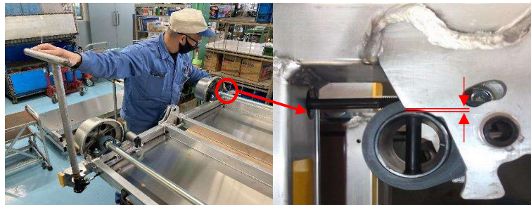
(9)片方のハンドルガイドを回した時に、もう片方のハンドルガイドが干渉していないことを確認する。
