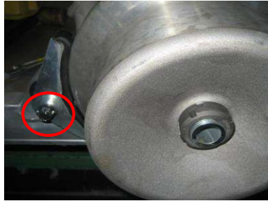
(2)割ピンを外し、ナットキャッスルを緩める。
